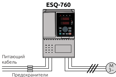
Рисунок 3-23. Схема установки предохранителей.
