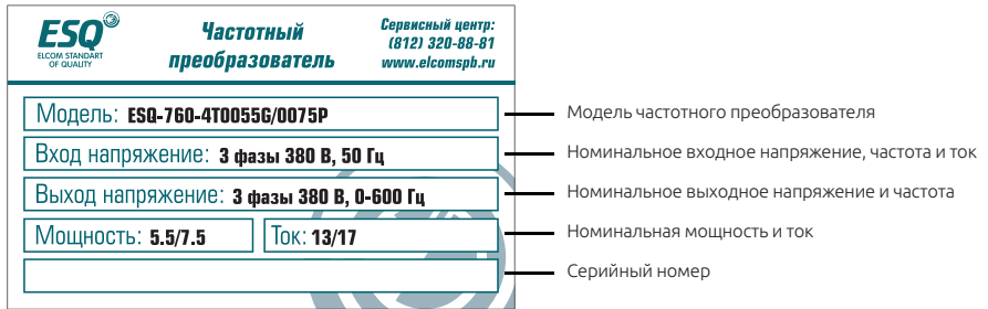
Рисунок 2-4. Изображение шильды частотного преобразователя ESQ-760
